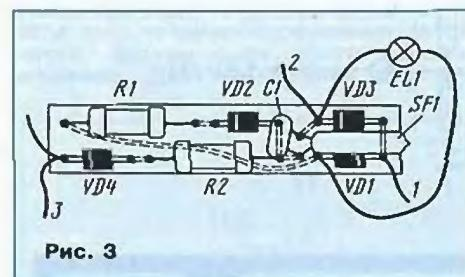
т.е. на напряжение 127 В. От этого же стартера можно использовать и конденсатор, либо применить любой другой емкостью до 0,5 мкФ на номинальное напряжение не менее 250 В.
